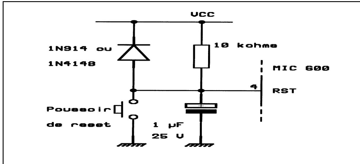
Ce schéma peut aussi être utilisé (avec ou sans le poussoir) si la tension d'alimentation appliquée au MIC 600 ne s'établit à sa valeur nominale que très lentement ou si cette tension est susceptible de sortir de la plage 4 à 6 volts pendant le fonctionnement normal du circuit.
