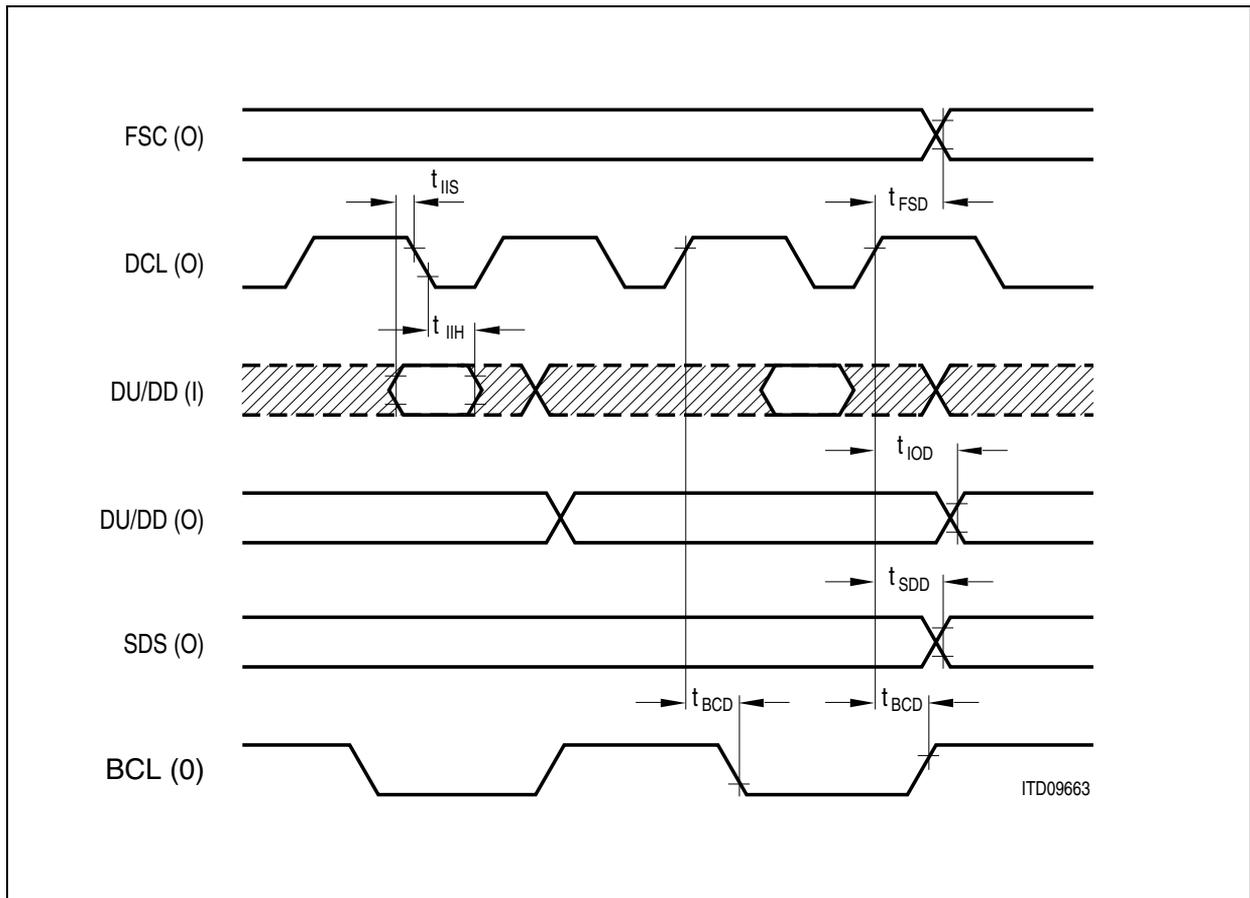
Figure 140 IOM<sup>®</sup> Timing (TE mode)
