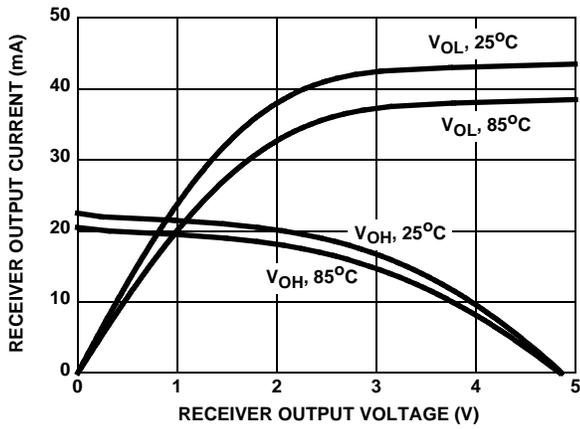
FIGURE 14. RECEIVER OUTPUT CURRENT vs RECEIVER OUTPUT VOLTAGE
