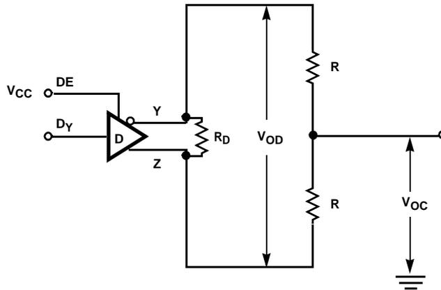
FIGURE 1. RS-485 DRIVER  $V_{OD}$  AND  $V_{OC}$  TEST CIRCUIT
