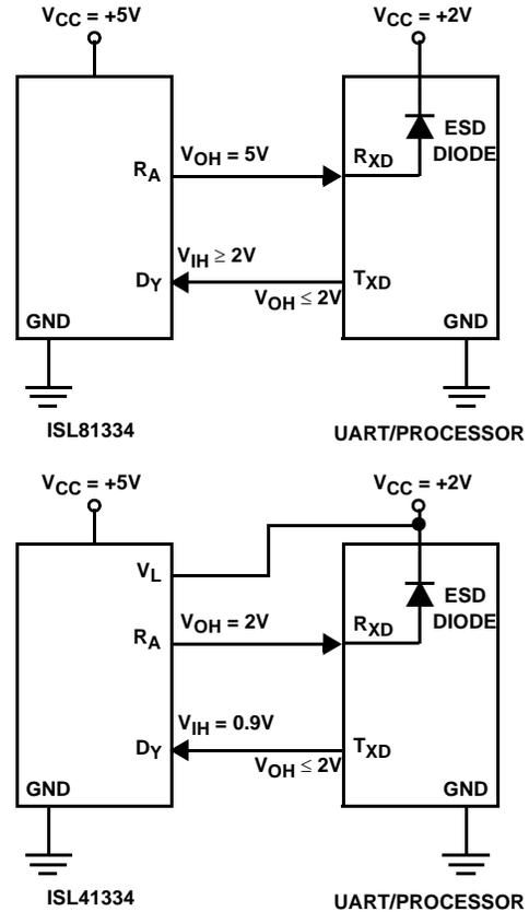
FIGURE 12. USING V<sub>L</sub> PIN TO ADJUST LOGIC LEVELS
