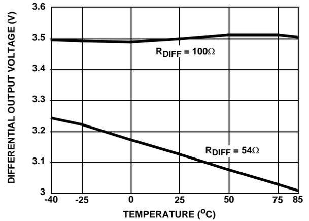
FIGURE 17. RS-485, DRIVER DIFFERENTIAL OUTPUT VOLTAGE vs TEMPERATURE
