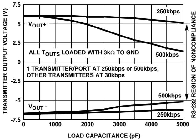
FIGURE 34. RS-232, TRANSMITTER OUTPUT VOLTAGE vs LOAD CAPACITANCE
