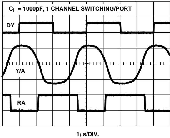
FIGURE 38. RS-232, TRANSMITTER AND RECEIVER WAVEFORMS AT 500kbps
