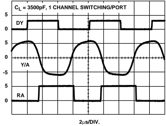
FIGURE 37. RS-232, TRANSMITTER AND RECEIVER WAVEFORMS AT 250kbps
